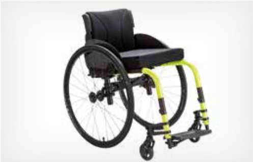
Een vastframe rolstoel die vouwt
